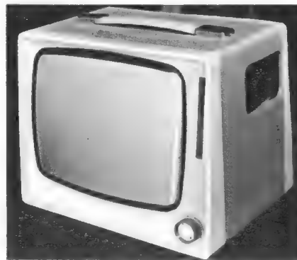
Bild 2. Laborgerät mit der 28-cm-Bildröhre
